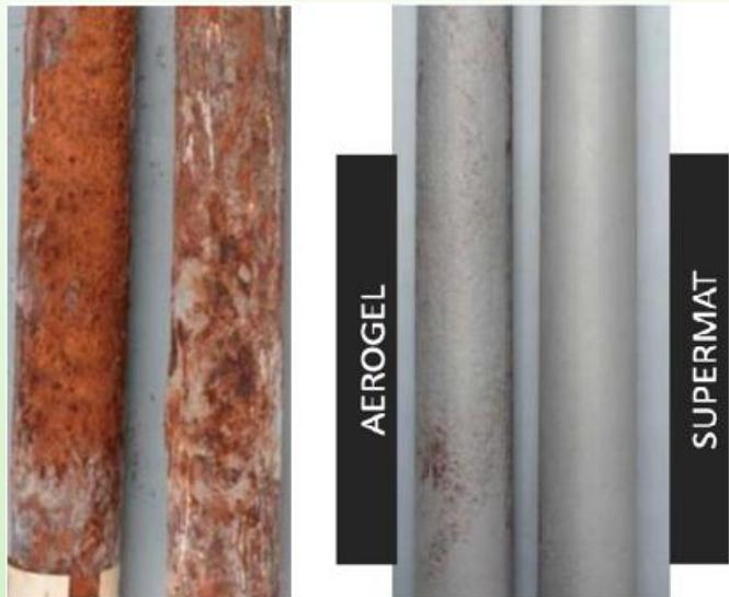
写真はCUI未対策配管、エアロゲルブランケット、SUPERMATを施工したCUI対策配管の6か月経過後の配管表面状態です。
