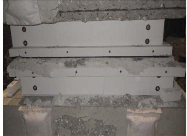
写真2 加熱試験後の試験体状況
